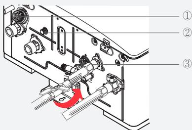
2 Снимите фильтр ГВС (3) , откручивая его против часовой стрелки с помощью монеты.
