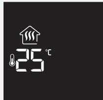
Установка температуры в помещении возможна регулировать на промежутке 5 ~ 40°C.
